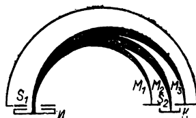
Рис. 13.8. Схема отклонения ионов различных масс в поперечном магнитном поле.
